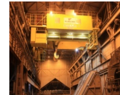
150 metric ton tapping crane (Swiss Steel)
